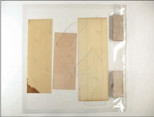
Abb. 5: Probepapiere in einer Hülle aus Melinexfolie, die mit einem Gemisch aus Ethanol und demineralisiertem Wasser im Verhältnis 9:1 gefüllt ist.
