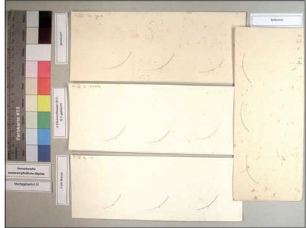
Abb. 6: Montagekarton IV b nach 15 Stunden Lichtbleiche mit Ethanol/Wasser (9:1). Rechts ist die unbehandelte Referenz zu erkennen, der unterste Streifen wurde mit 2 cm Wasserhöhe und der mittlere Streifen mit Ethanol/Wasser für 15 Stunden lichtgebleicht. Der obere Streifen wurde für acht Stunden gewässert.
