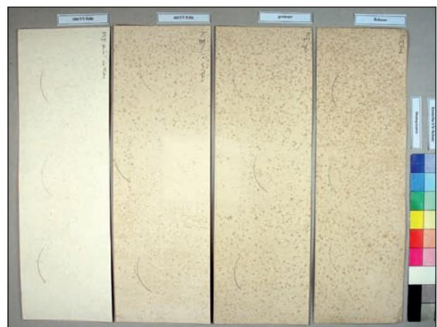
Abb. 3: Montagekarton II nach der Behandlung. Der rechte Papierstreifen ist die unbehandelte Referenz und der zweite von rechts, die gewässerte Probe. Der linke Streifen wurde ohne UV-Schutzfolie und der zweite von rechts mit UV-Schutz lichtgebleicht.
