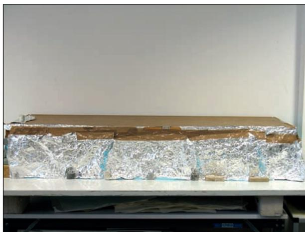
Abb. 1: Eine der Lichtbleichanlagen der FH Köln. In dem Holzrahmen sind fünf Leuchtstoffröhren des Typs L65/80 W79 von Osram montiert. Die Alufolie an den Rändern dient dem Schutz vor der für die Augen schädlichen UV-Strahlung.
