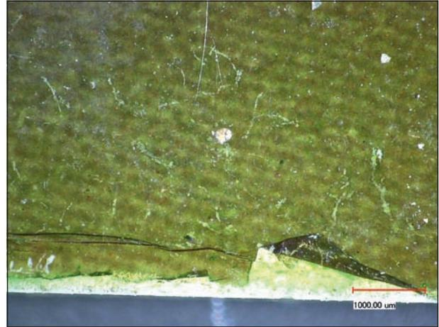
Abb. 4: Detailaufnahme des Randbereichs bei 50facher Vergrößerung. Am unteren Rand ist die eingerissene und umgeklappte Kollodiumhaut zu erkennen.
