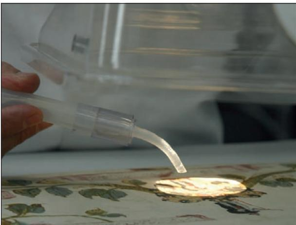
Abb. 8: Selbstgefertigte Düse für den Aerosolgenerator für bessere Arbeitsergonomie bei täglicher Vollzeitarbeit mit dem Gerät.
