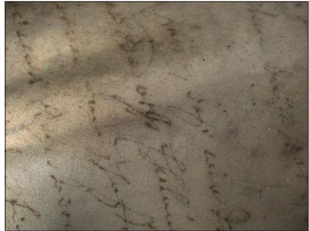
Abb. 12 und 13: Pergamentfragment mit Bauschuttstaub vor und nach der Trockenreinigung mit Latexschwamm.
