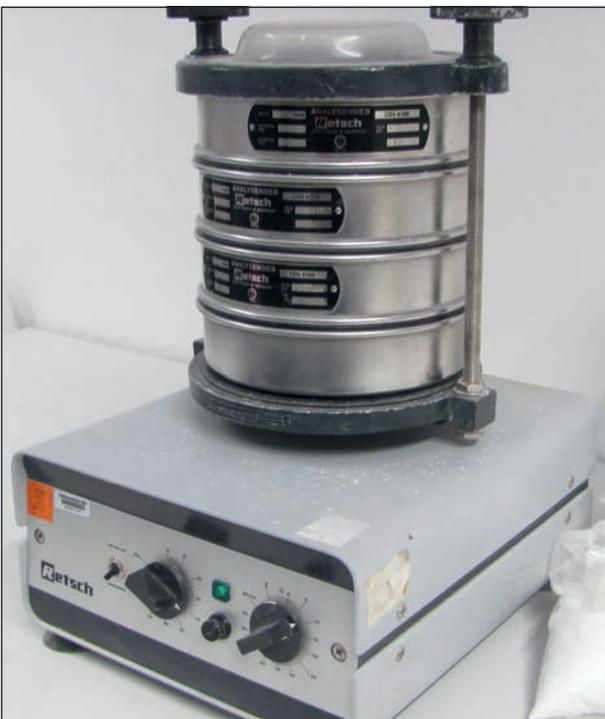
Abb. 2: Rüttelturm zum Fraktionieren der Strahlmittel.
