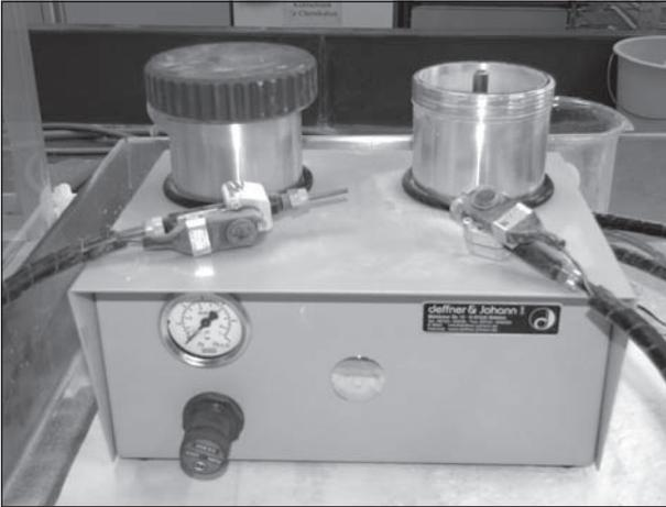
Abb. 1: Zweikammer-Strahlgerät.
