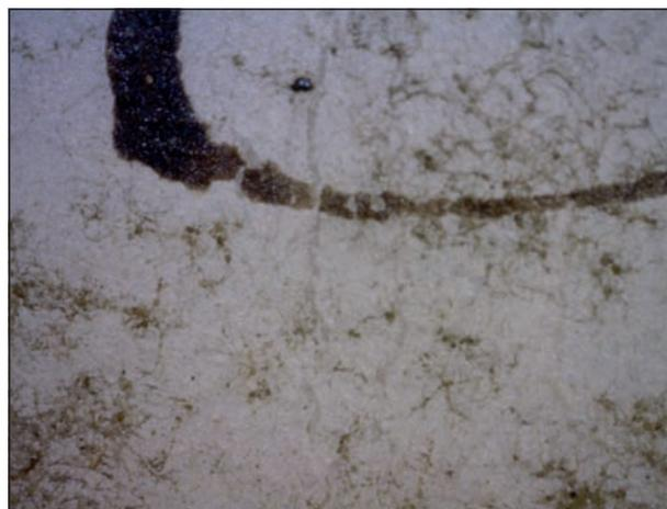
Abb. 6: Verluste durch intensives Reinigen mit einem Latexschwamm.
