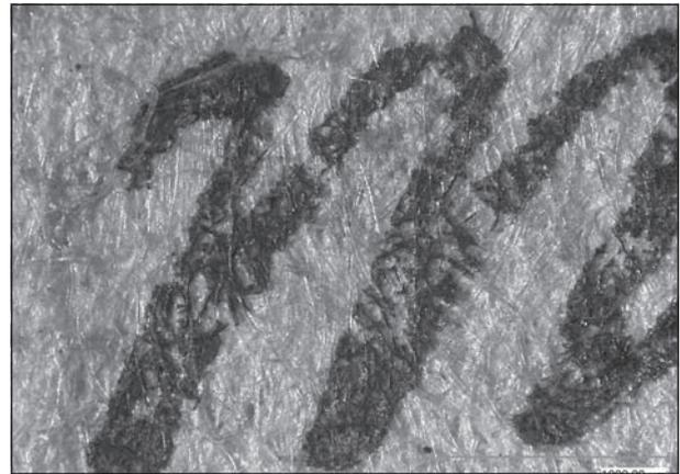
Abb. 12: Hadernpapier. Die Oberfläche konnte mit Weizenstärkepulver unbeschädigt gereinigt werden.
