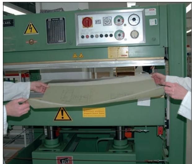
Abb. 9: Einlegen von Objekten in die Furnierpresse zum Aufbringen einer partiellen Kaschierung mit Archibond tissue.
