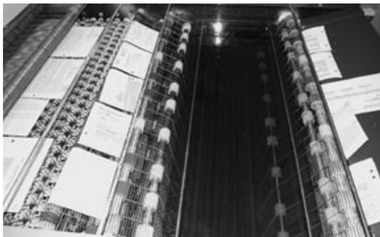
Abb. 1: Der Tränkungs- und Trockenteil der Kleinanlage C 900
