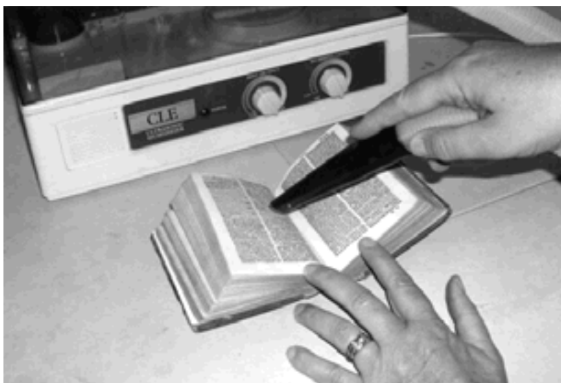
Abb. 4: Aerosolbehandlung mit 70 % igem Ethanol – hier eines leicht mit Schimmelpilz befallenen Buches
