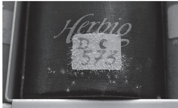
Abb. 3: Der Bereich um das Selbstklebeetikett ist besonders wasserundurchlässig, daher bildet sich dort bevorzugt ein Schimmelpilzbefall. (Farbabb. s. S. 152)
