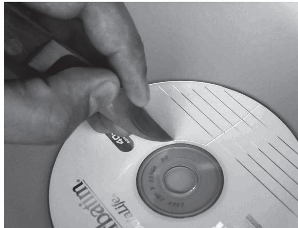
Abb. 9: Mit einem Messer wird die Oberfläche bis auf die Polycarbonatschicht eingeritzt
