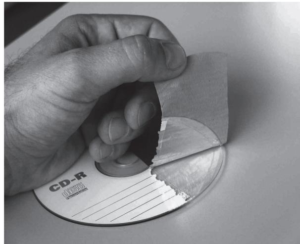
Abb. 10: Die eingeritzte Stelle wird mit einem Klebeband abgezogen
