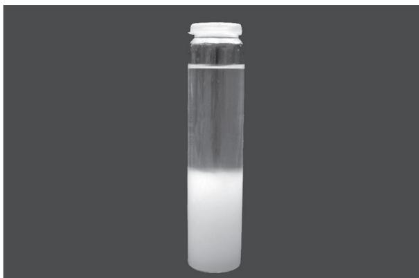
Abb. 2: 4%iger Weizenstärkekleister wurde mit Wasser auf die 1,5fache Konzentration verdünnt. Innerhalb kurzer Zeit fiel die Stärke aus
