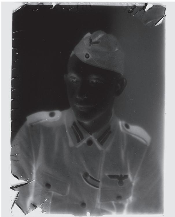
Abb. 8: Das Glasnegativ nach der Silberspiegelentfernung nach Edith Weyde. Aufnahme im Auflicht. Der Silberspiegel konnte gut entfernt werden, jedoch sind hier massive mechanische Beschädigungen der Emulsionsschicht zu verzeichnen. Die Emulsion konnte den nasschemischen Behandlungen nicht standhalten und löste sich im Randbereich (Farbabb. s. S. 150)
