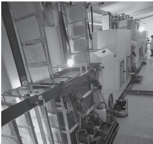
Abb. 2: CoMa 2 (Bückerburg) Zwei-Bad-Prinzip, Transportsystem mit Rahmenanlage, außer Betrieb
