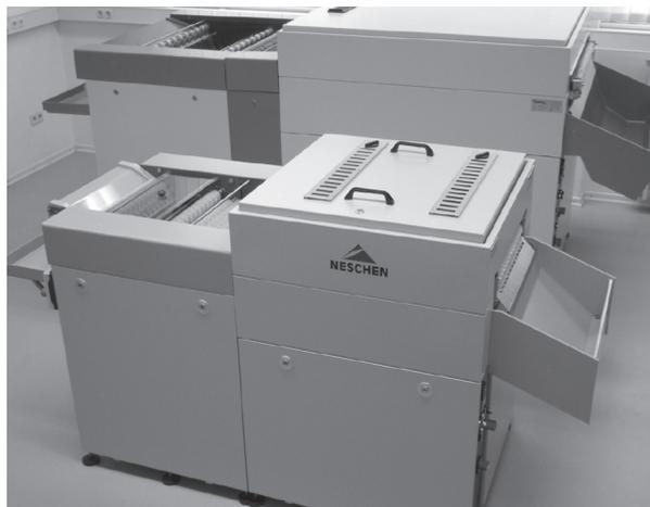
Abb. 6: C 500, Ein-Bad-Prinzip, transportable Kleinanlage für externe Vorführungen mit identischer Technik wie bei der C 900-2, in Betrieb seit 2007 (im Hintergrund eine C 900)
