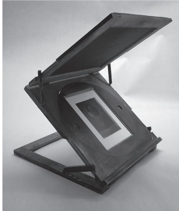
Abb. 8: Retuschepult aus dem Fotoarchiv Kleu, um 1930. Das Pult wurde bis Anfang der 1970er Jahre zum Retuschieren von Negativen benutzt (Farbabb. s. S. 149)
