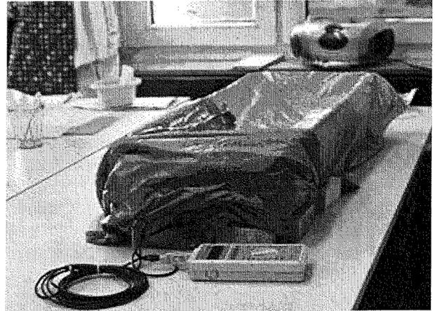
Abb. 3: Die Klimakammer zur Einstellung von 33 % r.F.
