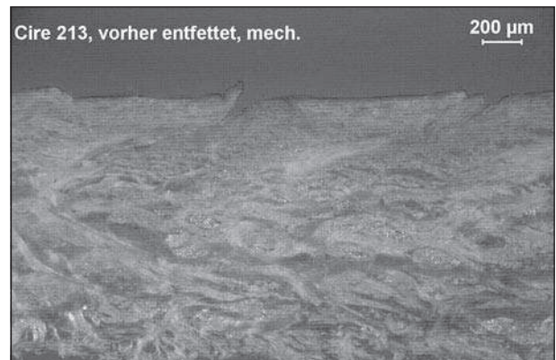
Abb. 2: Linke Reihe: Anfärbungen des nachgefetteten Probenleders, vor der Nachfettung entfettet; rechte Reihe: zusätzlich mechanisch behandelte Proben (Auflicht, 50fache Vergrößerung)
