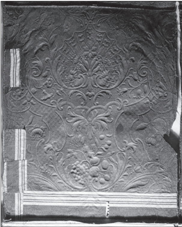
Abb. 18: Die Verwellungen des Goldleders durch unterschiedliches Dehnungsverhalten der vorhandenen Materialien sind im Streiflicht besonders deutlich.
